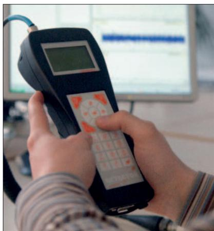
неисправности оборудования посредством анализа вибраций и устанавливать причину повреждений, исходя из колебательных сигналов и частотного спектра.
