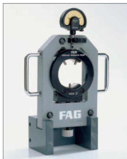
Измерительный прибор FAG MGA 31 для регулирования радиального зазора цилиндрических роликовых подшипников со съемными наружными кольцами
