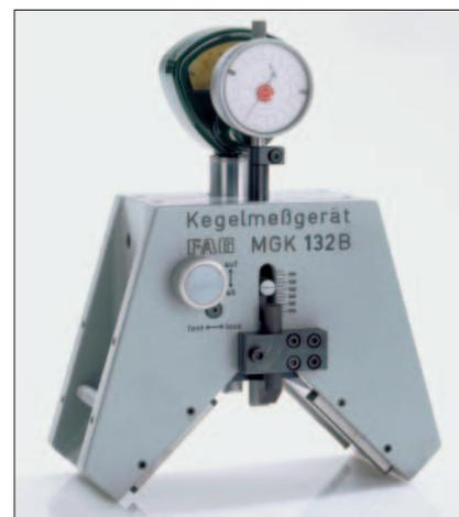
Измерительный прибор для конических поверхностей FAG MGK 132
